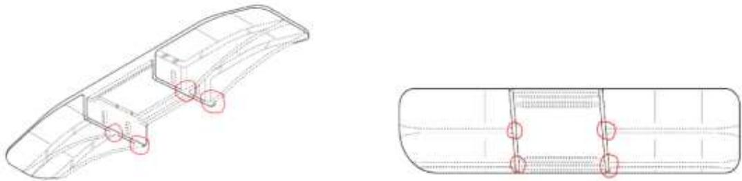
изображения промышленного образца (элемент направляющий для полотна жатки) с разных ракурсов поданы с использованием пунктирных линий для отображения тех частей (элементов) внешнего вида изделия, на правовую охрану которых заявитель не претендует, однако некоторые элементы в одном ракурсе выполнены полностью сплошными линиями, в другом – эти линии прерываются.
